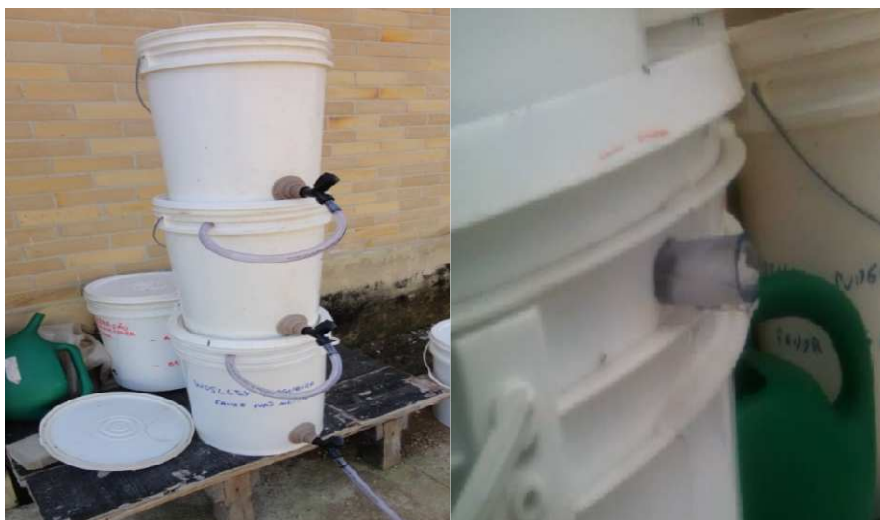
Figura 5- Novo sistema de filtros desenvolvido para a captação de amostras de água tratada.
