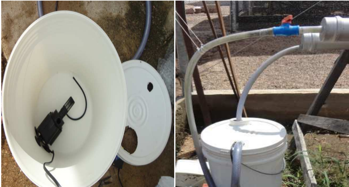
Figura 10- Bomba submersa para elevação da solução nutritiva.
