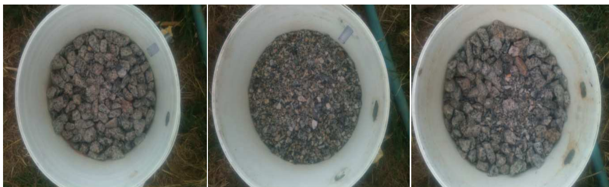
Figura 2. Diferentes granulometrias de britas para os filtros 1, 2 e 3 (da esquerda para a direita).
