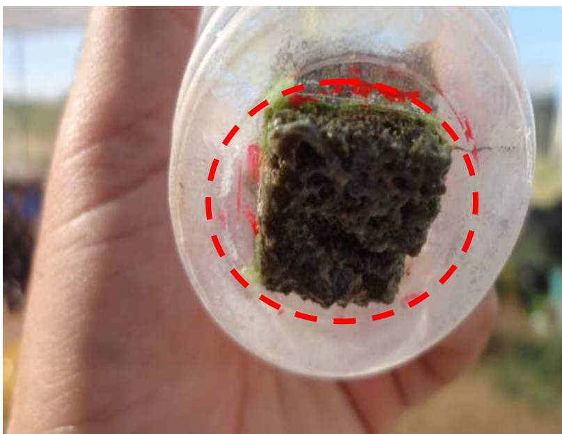
Figura 26- Óleo e gordura da água cinza aderida a espuma fenólica.
