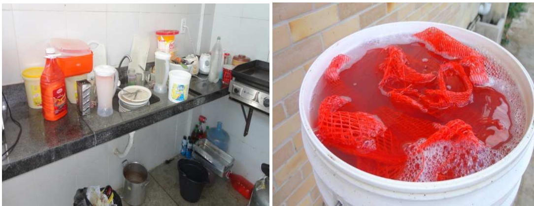
Figura 13- Local de coleta da água servida (cantina UFCG-CCTA) e filtro alimentado.
