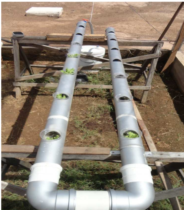
Figura 7- Canais para sustentação da alface e escoamento da solução nutritiva.
