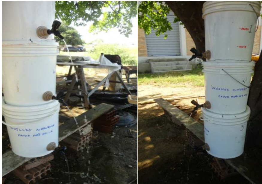
Figura 4. Teste de percolação dos filtros com água limpa.
