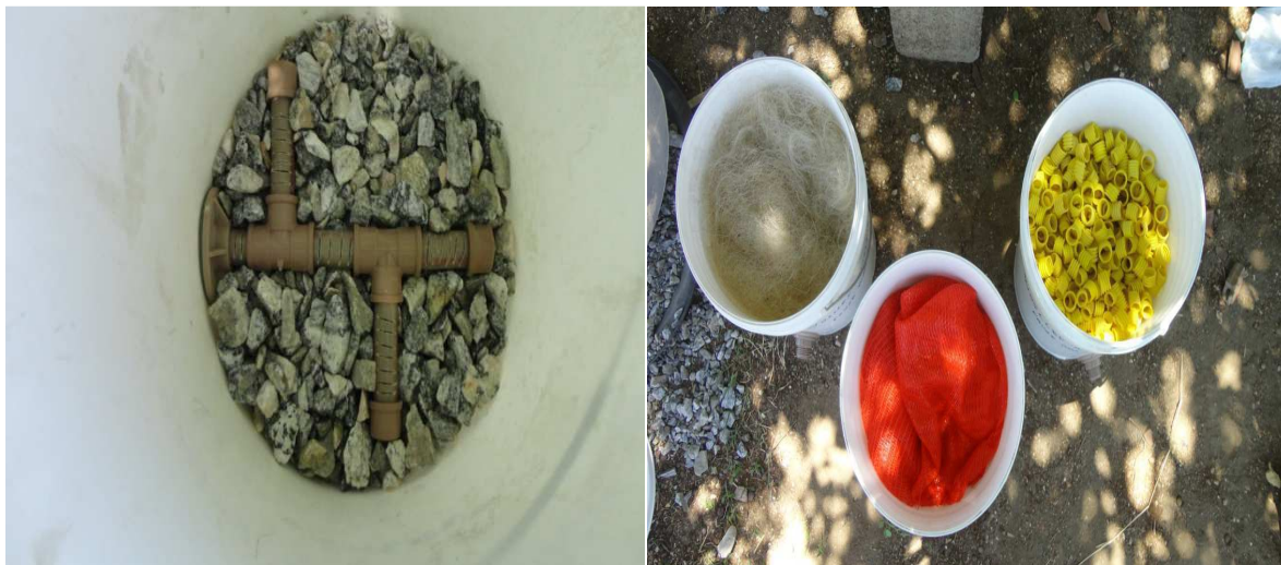
Figura 3. Cano perfurado para drenagem de água dos filtros (esquerda). Filtros com confecção concluída (direita).
