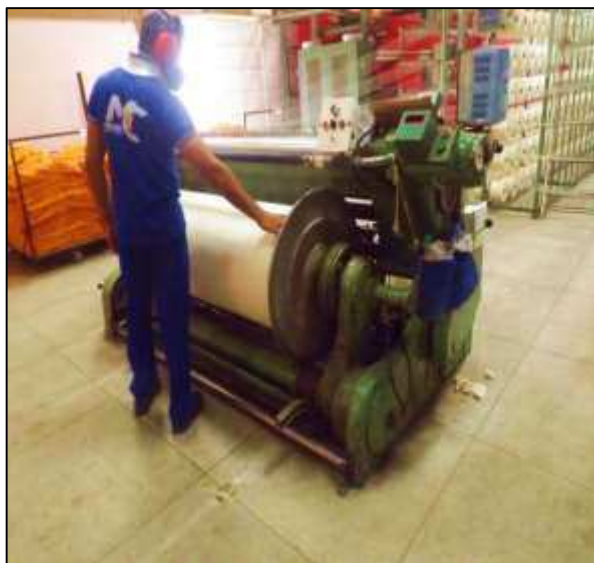
Figura 4 - Etapa de Urdimento, com a preparação do fio para a tecelagem
