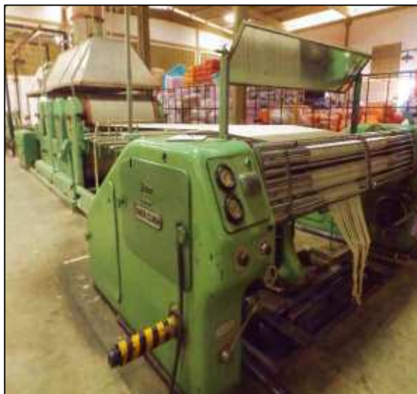
Figura 5 - Etapa de engomagem: preparação do fio para a tecelagem
