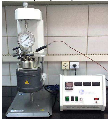
Figura 22. Reator Paar modelo 4848 para produção de biodiesel.
