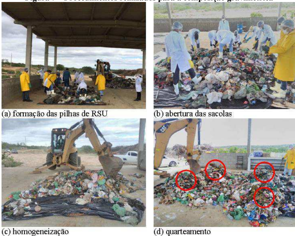
Figura 7 – Procedimentos realizados para a composição gravimétrica
