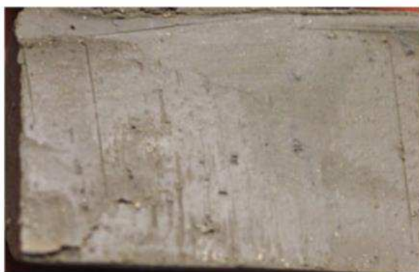
Figura 2.18: Distribuição interna de umidade em uma amostra seca com aquecimento controlado por micro-ondas em 122 min de secagem. Fonte: Vorhauer et al. (2019).
