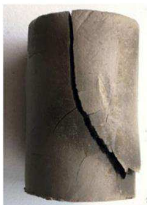
Figura 2.17: Amostra cilíndrica deteriorada de altura 49 mm e diâmetro 33 mm. Fonte: Vorhauer et al. (2019).
