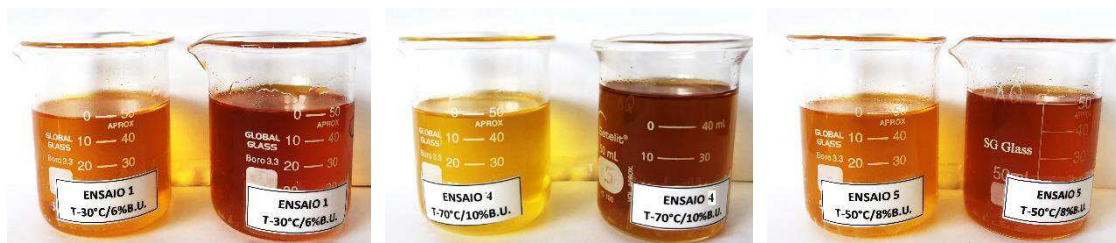
Figura III.4- Óleos das sementes de abóbora, submetidos a fotoxidação e termoxidação
