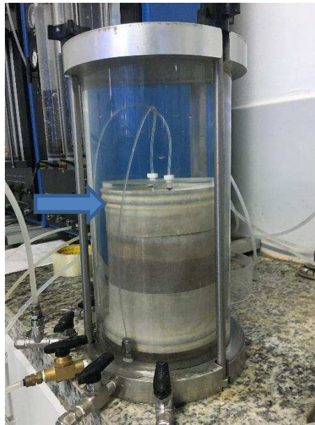
Figura 10: Câmara de permeabilidade com corpo de prova evidenciando a frente de umidade na saturação
