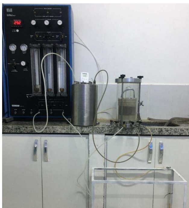
Figura 12: Ensaio de permeabilidade ao lixiviado
