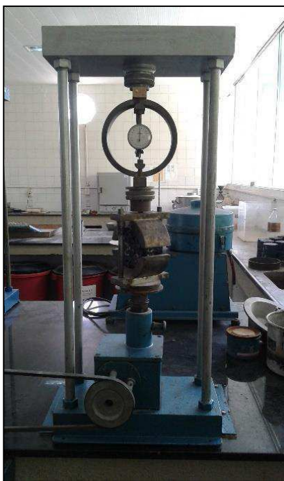
Figura 52: Ensaio de estabilidade Marshall
