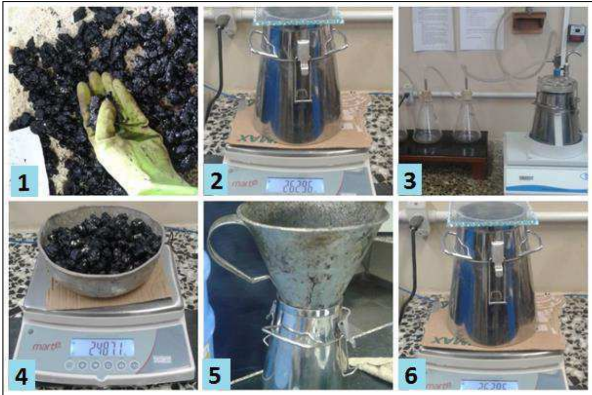
Figura 44: Sequência do Rice teste
