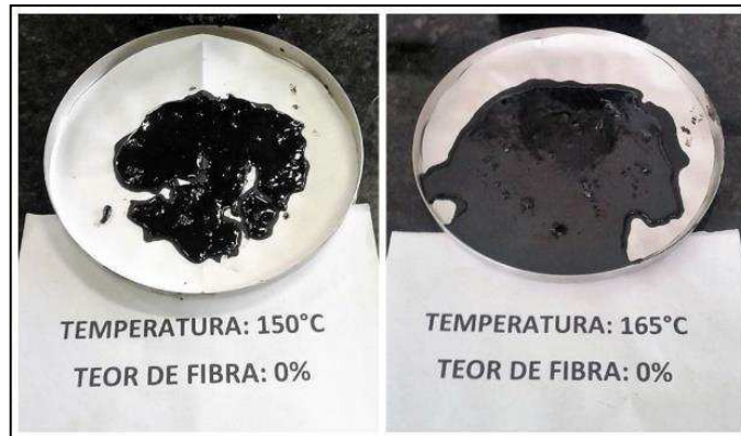
Figura 66: Escorrimento da mistura SMA sem aditivo estabilizador
