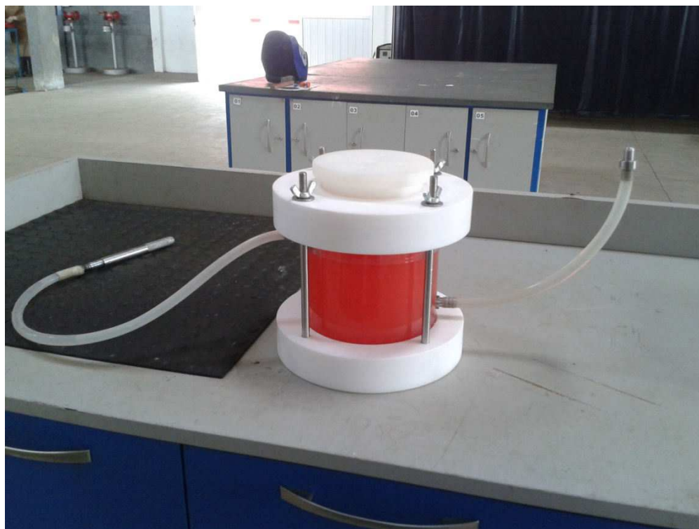
Figura 55 – Fotografia da célula encamisada para ensaios de corrosão aquosa
