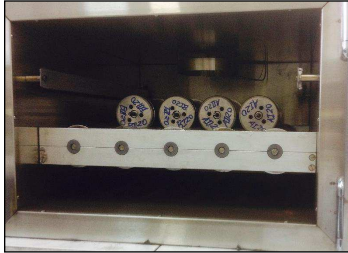
Figura 11 - Células de envelhecimento de fluidos no forno roller oven , Fann.
