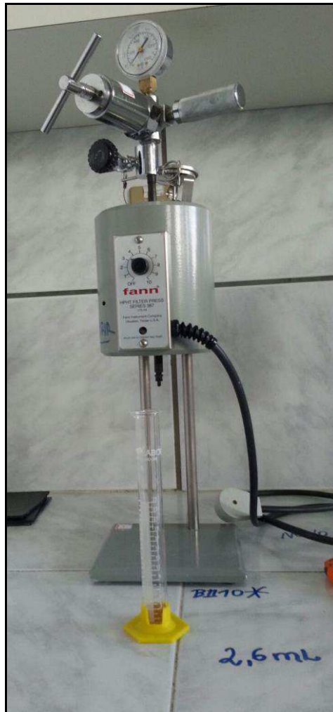
Figura 14 - Filtro prensa HPHT da Fann com alíquota do fluido BII10.
