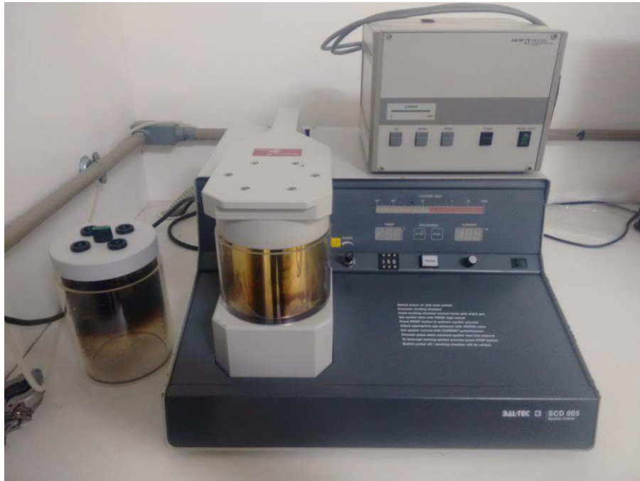
Figura 17: Metalizador utilizado para a preparação de amostras Fonte: Autor, 2015
