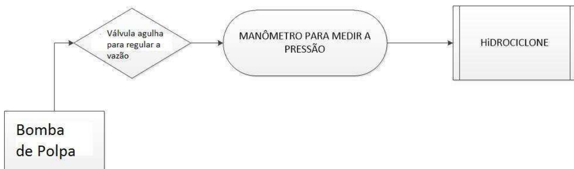
Figura 13: Arranjo de equipamentos e acessórios utilizados para a realização dos ensaios Fonte: Autor, 2015.
