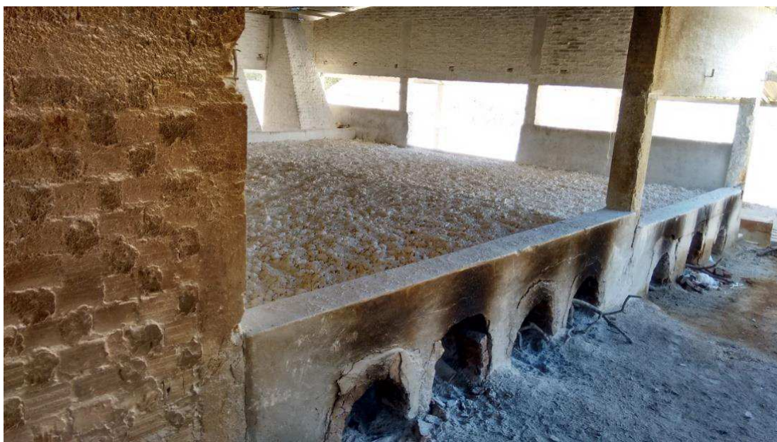
Figura 9: Secagem do concentrado de caulim em fornos a lenha – Mineração São João. (Autor, 2015).
