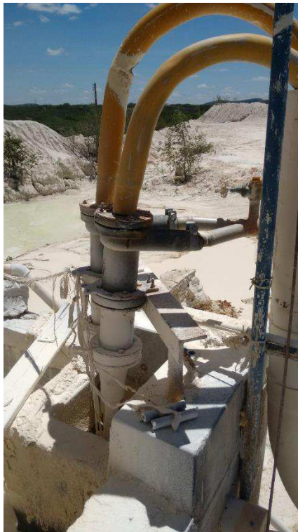
Figura 12: Hidrociclone da Unidade de Beneficiamento da JPR Mineração Fonte: Autor, 2015
