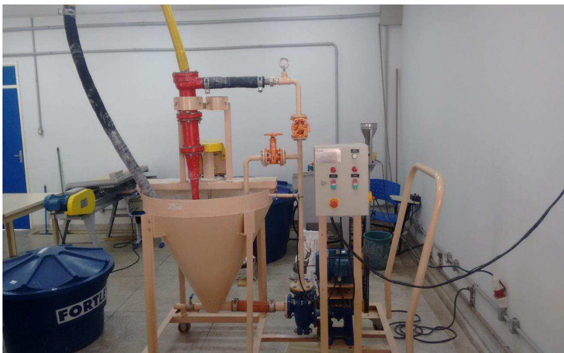
Figura 19: Hidrociclone utilizado para testes de bancada no IFPB- Campina Grande
