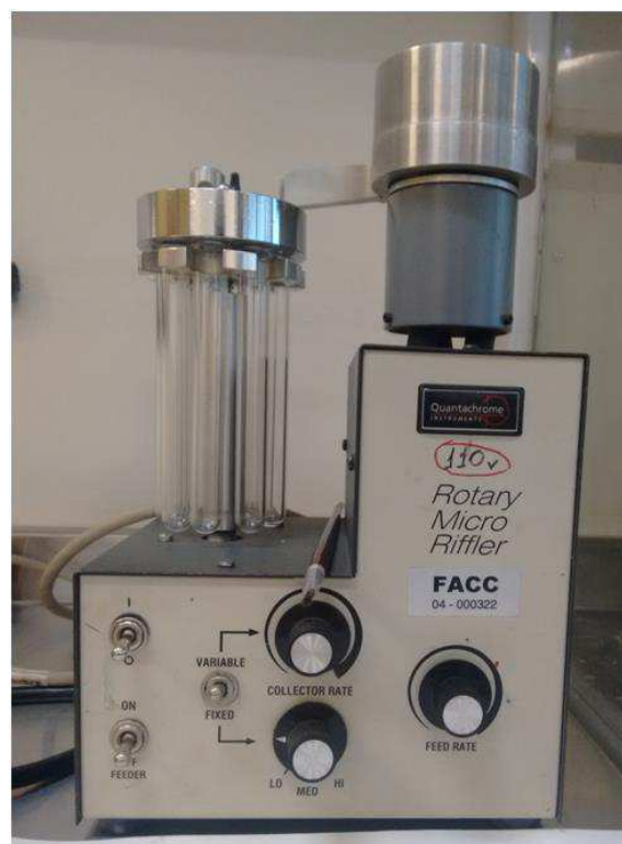
Figura14: Quarteador utilizado para a separação das amostras. Fonte: Autor, 2015
