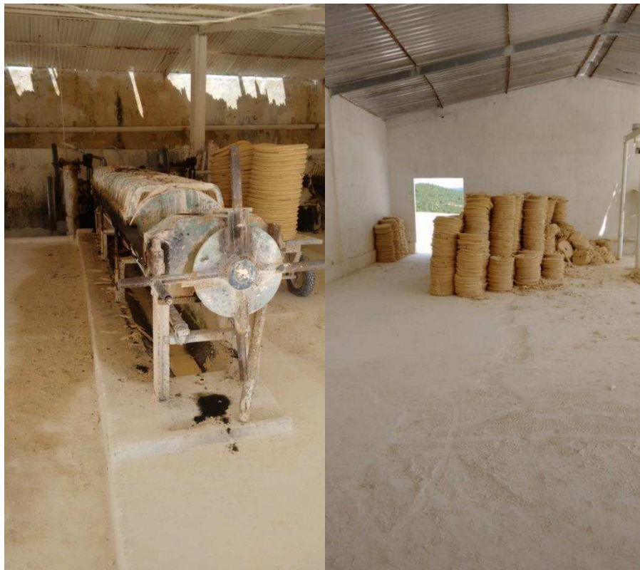
Figura 8: Filtro prensa utilizado na filtração e confecção das tortas – Mineração JM Silva (Autor, 2015).
