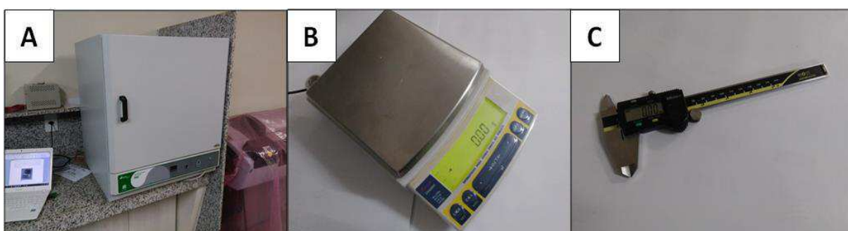
Figura 15: Equipamentos utilizados nas medições das dimensões. A) Estufa; B) Balança de precisão; C) Paquímetro digital.
