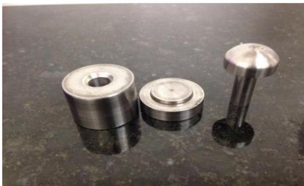
Figura 4 - Molde cilíndrico de metal para produção das amostras.
