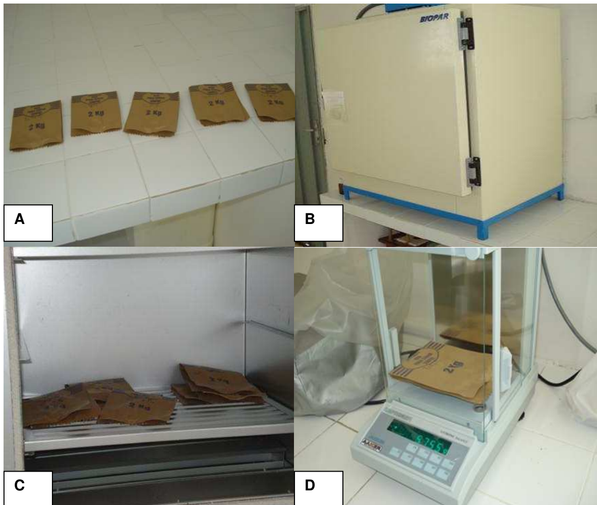
Figura 3 Equipamentos e procedimentos realizados para cálculo de massa seca de raízes: sacos de papel utilizados para colocar as raízes (A), estufa (B), sacos contendo raízes e sacos vazios colocados em estufa à 65°C (C) e balança para pesagem de massa seca (D)
