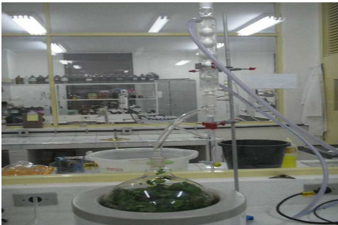
Figura 10 – Extrator de óleos essenciais, tipo Clevenger do LPPN – URCA – Crato-CE Fonte: BRITO, H.R. – setembro de 2009
