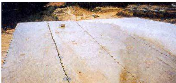
**Figura 2 - Corte em granito através de argamassa expansiva.**
