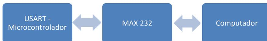
**Figura 45 - Comunicação serial da maquina de ensaios**
