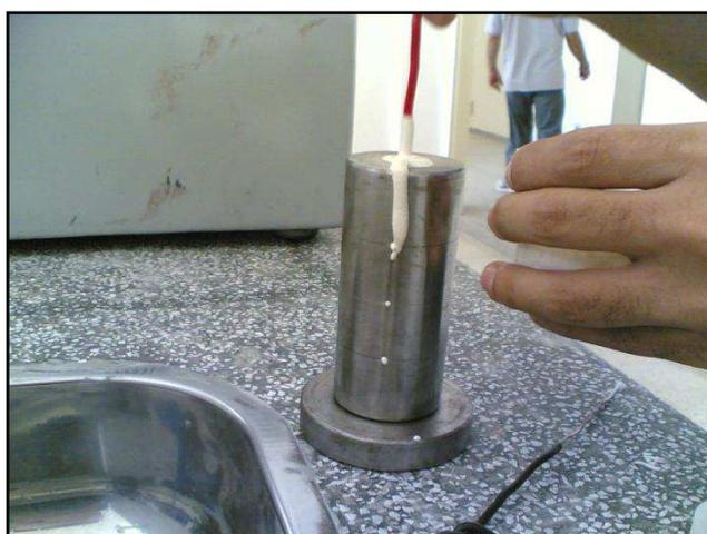
**Figura 69 - Molde sendo preenchido com argamassa expansiva**
