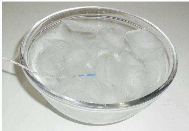
**Figura 81 - Banho de água e gelo com o termopar**
