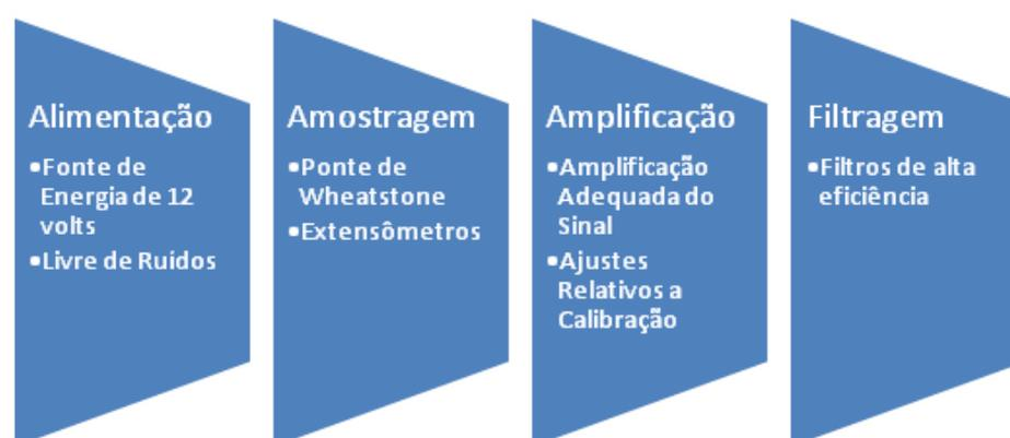
Figura 49 - Etapas do condicionamento de sinal da célula de carga
