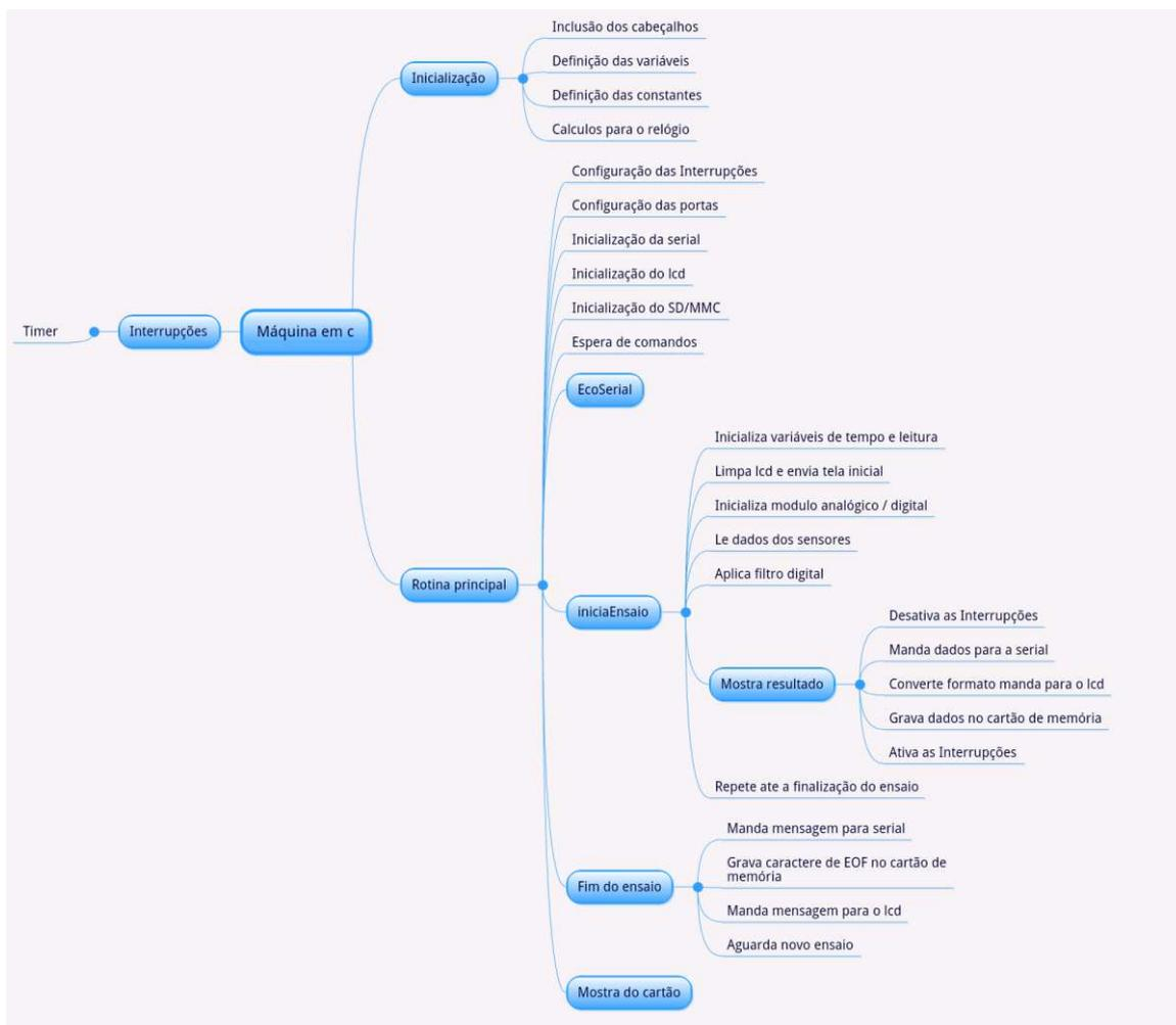
**Figura 68 - Diagrama da camada controle do programa embarcado**
