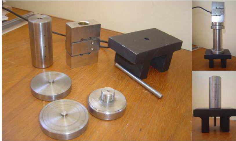
**Figura 35 - Peças prontas para o molde. À direita no canto superior tem-se molde montado com a célula de carga. Na parte inferior, pino de limpeza no centro do molde**
