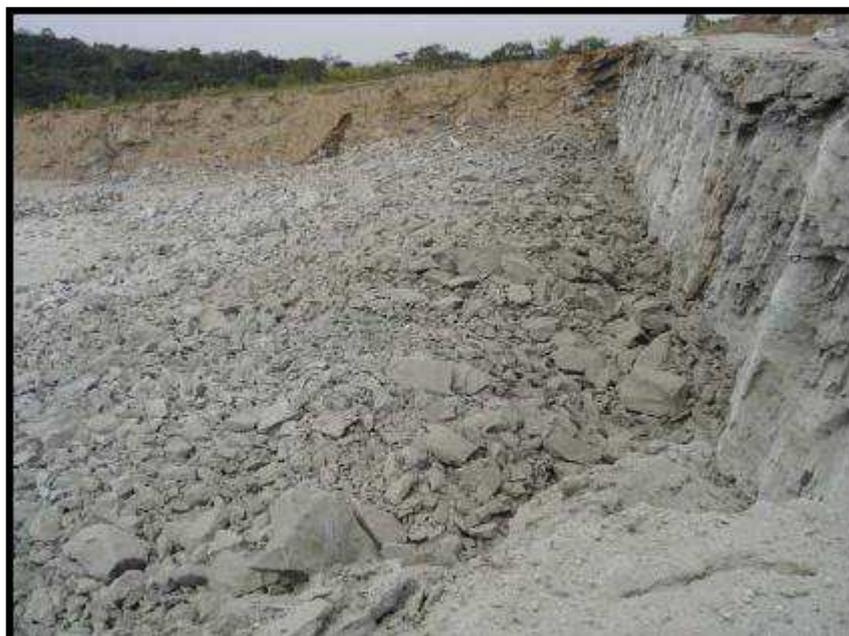
**Figura 3 - Material desagregado por bancada**
