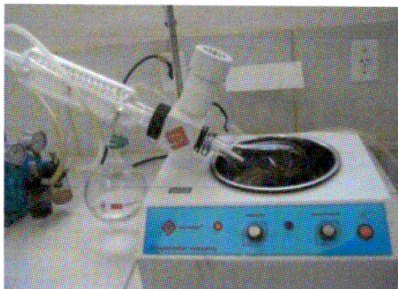
Figura 1. Evaporador rotativo utilizado no processo de reciclagem
