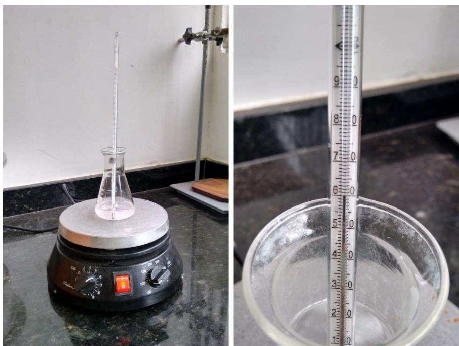
Figura 16 – Sistema de agitação e aquecimento na preparação dos monólitos vítreos silicoaluminosos pelo processo sol-gel. Fonte: Própria (2016).
