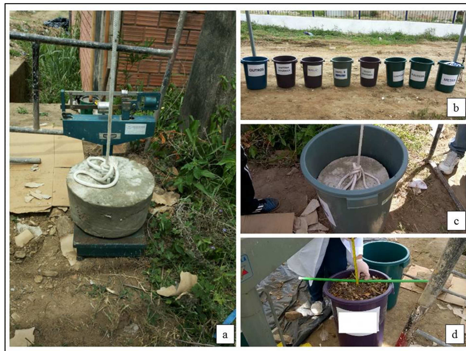
Figura 30 – a: Pesagem do soquete; b: identificação dos recipientes; c: aplicação do carregamento; d: medição da altura e diâmetro ocupado pelos resíduos.
