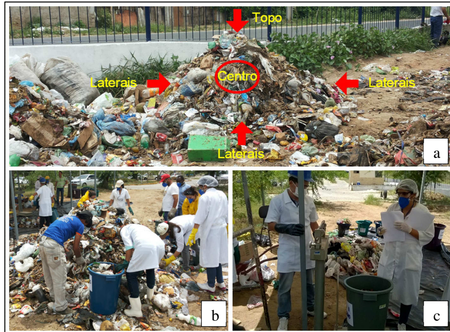
Figura 29 – a: locais de retiradas da amostra; b: resíduos para composição; c: pesagem do material.
