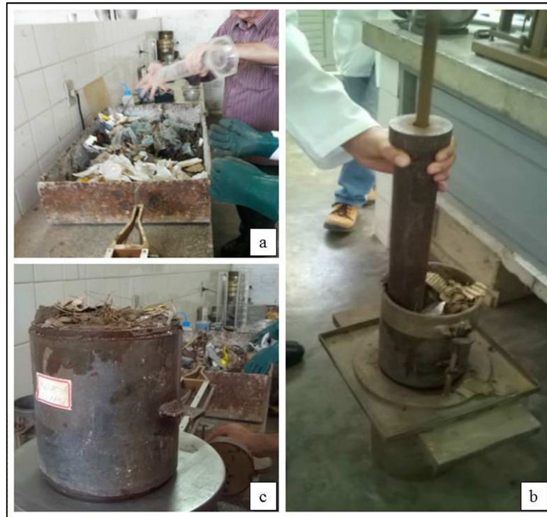
Figura 34 – Realização do ensaio de compactação. a: adição de água à amostra; b: aplicação da energia Proctor Normal; c: corpo de prova após a compactação.
