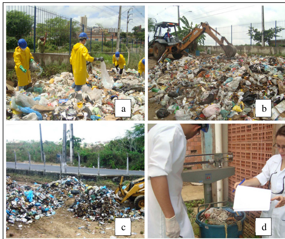
Figura 22 – a: abertura das sacolas; b: homogeneização; c: quarteamento; d: pesagem para enchimento da célula experimental.
