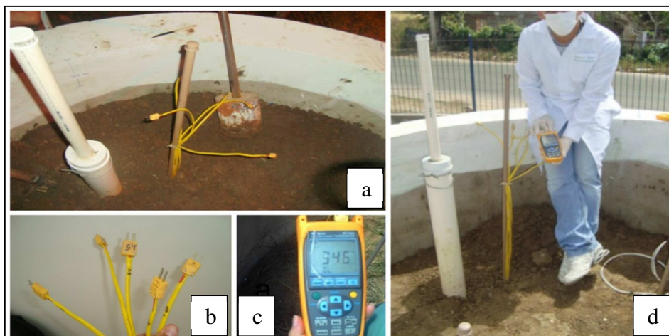
Figura 16 – a: termopares no centro da célula experimental; b: termopares; c: termômetro digital; d: monitoramento da temperatura.
