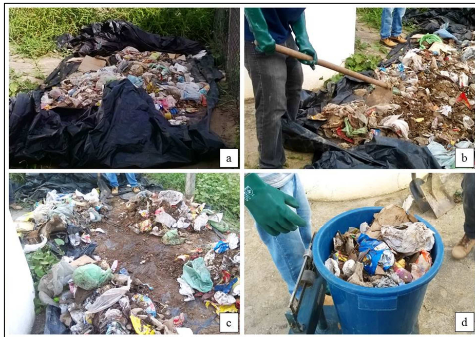
Figura 31 – a: secagem dos resíduos ao ar livre; b: homogeneização manual dos resíduos; c: quarteamento; d: pesagem de 10 Kg de amostra para ser levada ao laboratório.
