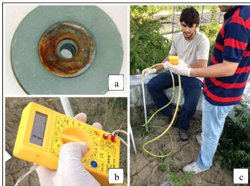
Figura 25 – a: placa de recalque em profundidade; b: ohmímetro; c: inserção do sensor magnético no tubo PVC.
