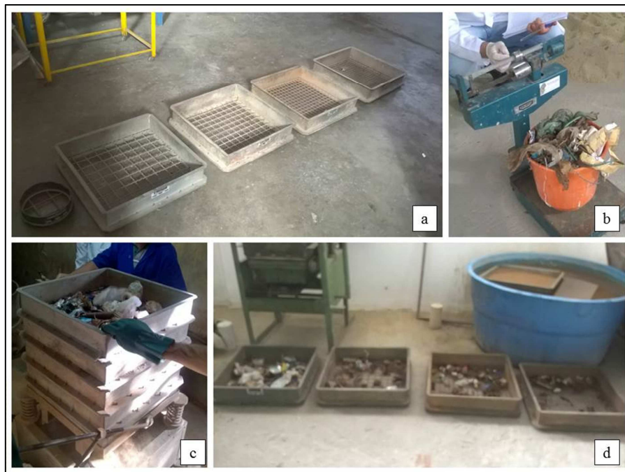
Figura 32 – a: série de peneiras; b: pesagem dos resíduos; c: peneiramento sob agitação mecânica; d: material retido nas peneiras.
