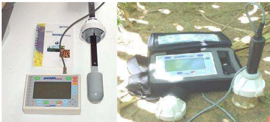
Figura 6. Sonda Diviner 2000<sup>®</sup> com seus componentes. Fonte: Sentek, 2000
