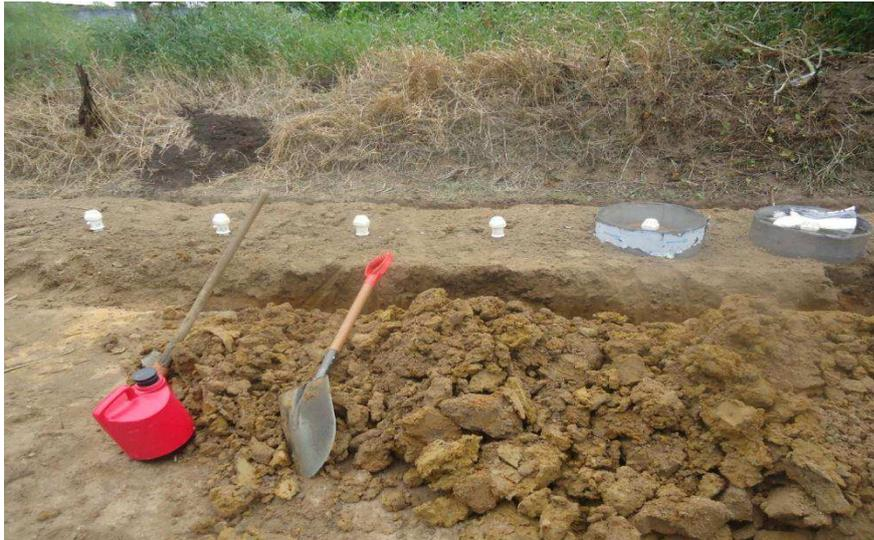
Figura 9. Tubos instalados para calibração da sonda de capacitância para o solo da área experimental
