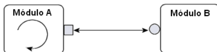
Figura 20: Interface bidirecional entre dois componentes.
