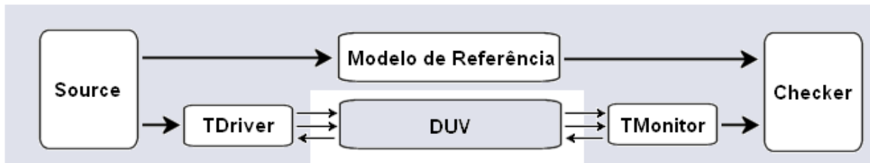
Figura 02: Testbench da metodologia VeriSC.
