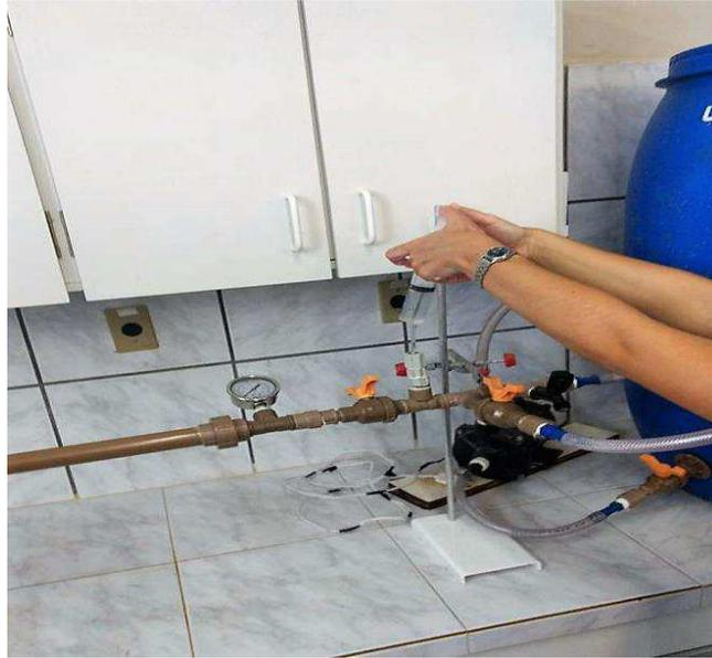
O monitoramento das concentrações do fluido composto pelo traçador em fluxo juntamente com a água de alimentação do sistema, sendo essa de abastecimento público local, na saída do sistema, foi realizado pelo método condutimétrico.
