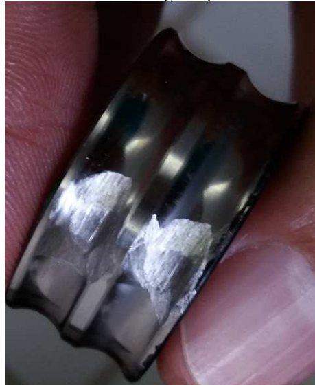
Figura 63 – Pista interna do rolamento com desgaste por abrasão de 3 mm após o experimento
