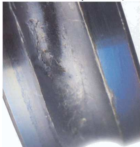
Figura 6 – Rolamento com falha por lubrificação inadequada
