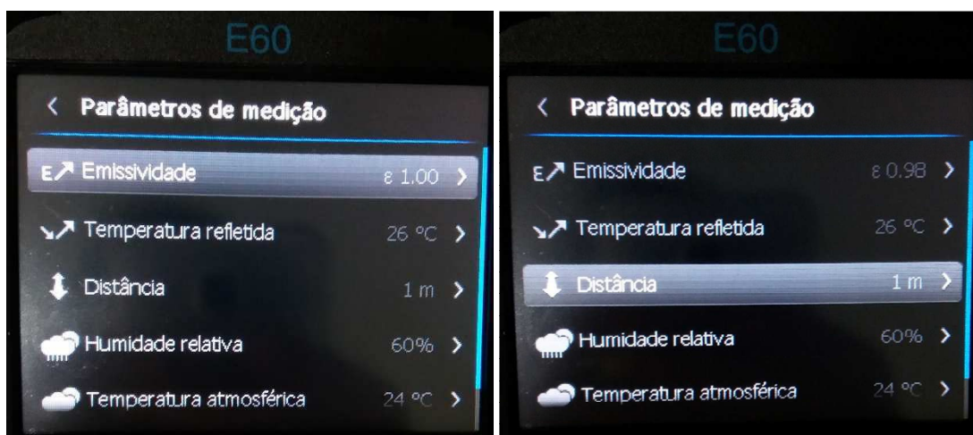
Figura A8 – Informações dos ajustes no termovisor para aferição da temperatura refletida e início dos testes, respectivamente
