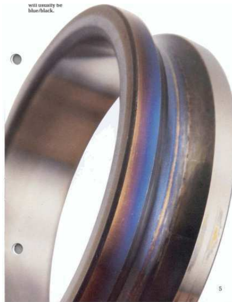
Figura 3 – Rolamento com desgaste severo por sobreaquecimento
