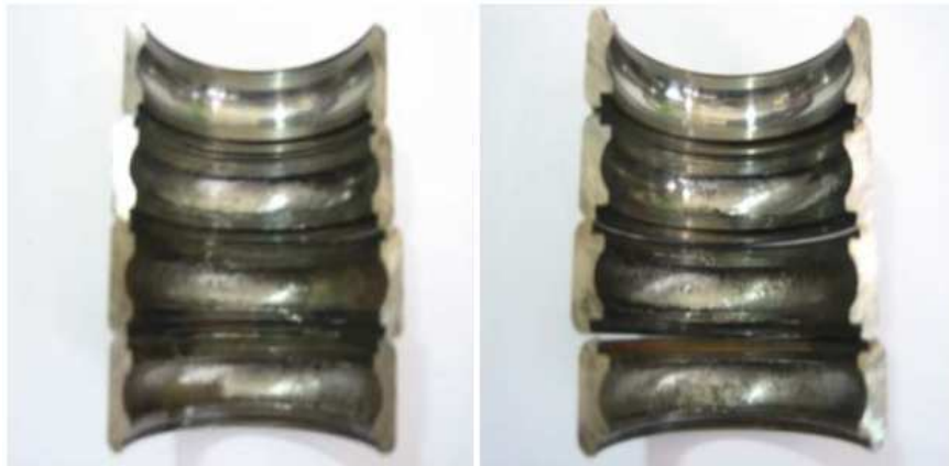
Figura 17 – Falhas por abrasão em pistas externas
