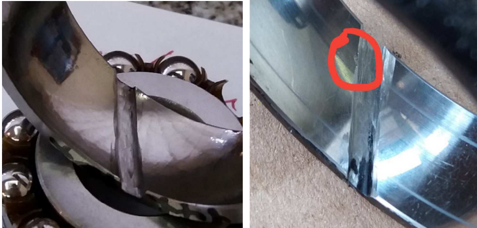
Figura 58 – Pista externa do rolamento com sulco de 3mm antes e depois do experimento, respectivamente
