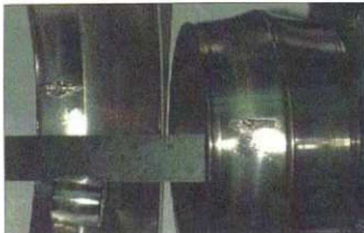
Figura 31 – Rolamento de esferas com falha por eletro-erosão
