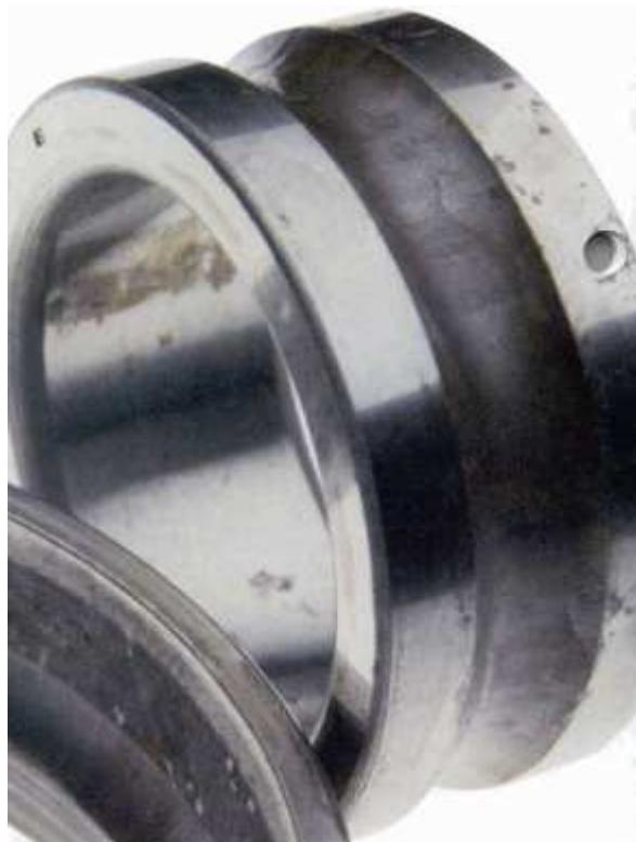
Figura 7 - Rolamento com falha por corrosão.
