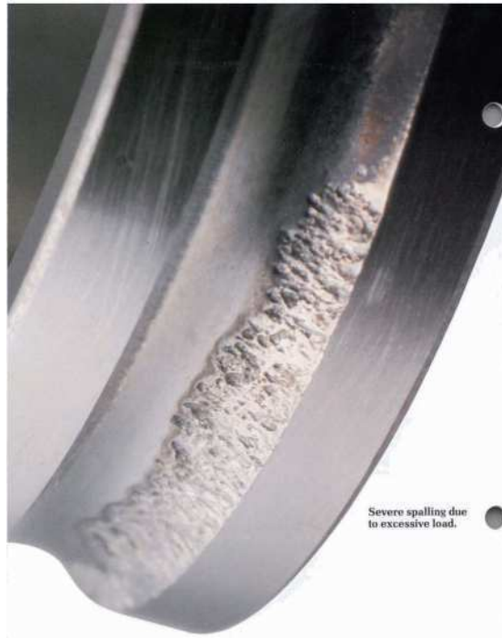
Figura 2 – Rolamento com desgaste severo por excesso de carga
