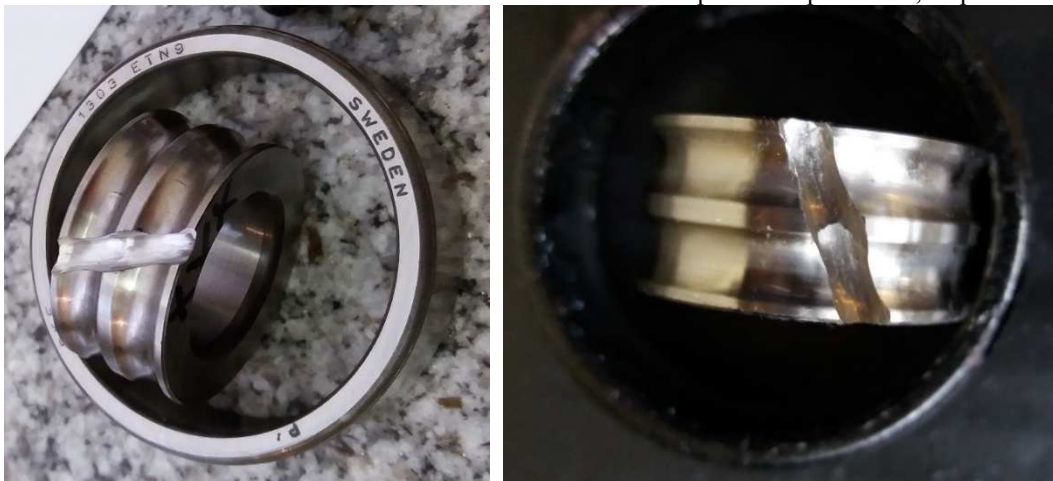
Figura 54 – Pista interna do rolamento com sulco de 3 mm antes e depois do experimento, respectivamente
