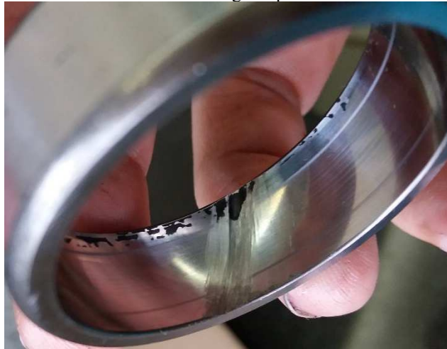
Figura 69 – Pista externa do rolamento com desgaste por abrasão de 3 mm após o experimento
