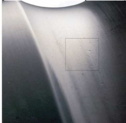
Figura 5 – Rolamento com falha por contaminação
