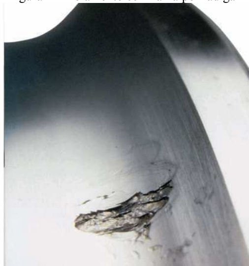
Figura 4 – Rolamento com falha por fadiga
