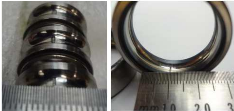
Figura 36 – Rolamento de esferas com falha por eletro-erosão nas pistas interna e externa, respectivamente
