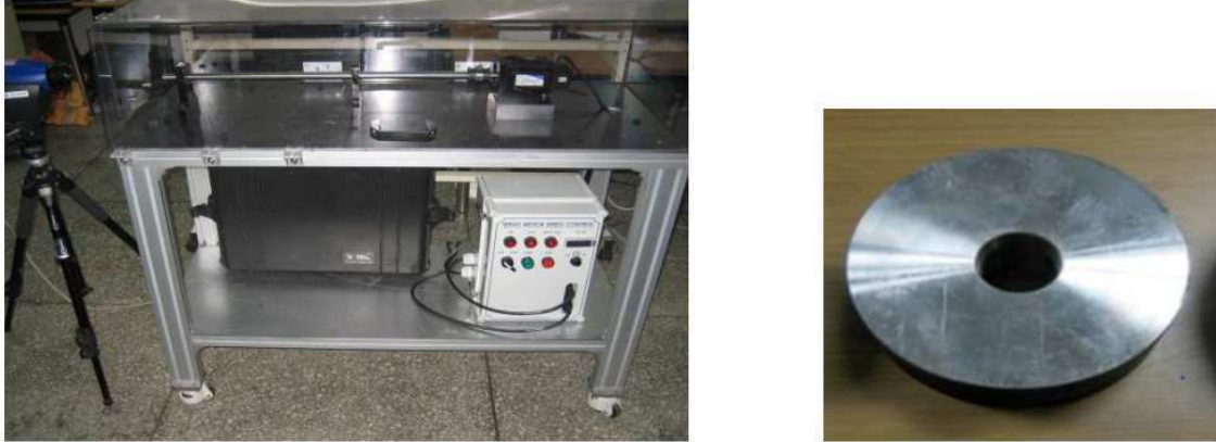
Figura 29 – Bancada de testes e disco em aço de 3 kg
