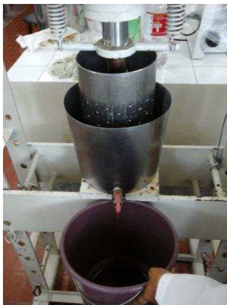
Figura 3.2 - Prensa hidráulica manual utilizada para extração do caldo das vagens de algaroba
