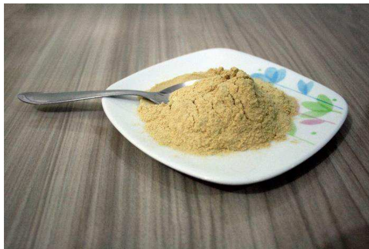
Figura 4.14 – Farinha residual de algaroba a 115 mesh obtida a 50°C
