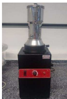
Figura 3.5 - Micro moinho utilizado para trituração do resíduo seco de algaroba
