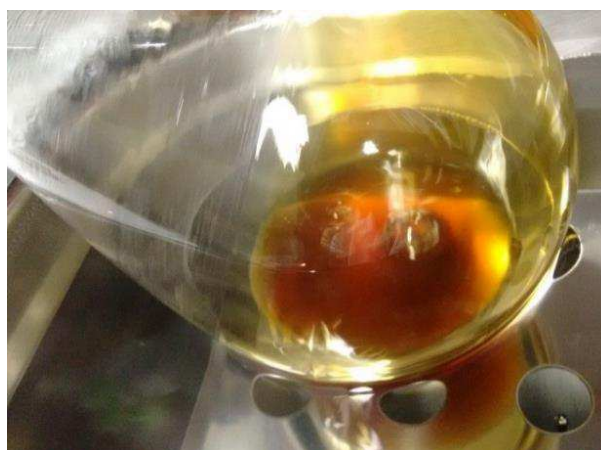
Figura 3.3 – Obtenção do açúcar líquido de algaroba utilizando-se o evaporador rotativo
