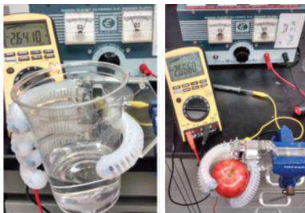
Figura 7. Teste da mão robótica desenvolvida com LMF embebidos em uma matriz de silicone.
