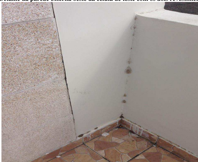
Figura 4.20. Detalhe da parede externa oeste da célula de teste com os dois revestimentos estudados.
