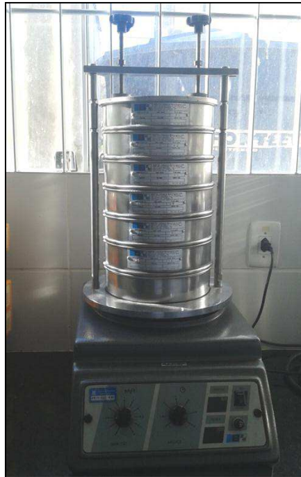
Figura 3.5. Agitador eletromagnético utilizado para caracterização granulométrica (O AUTOR, 2015).
