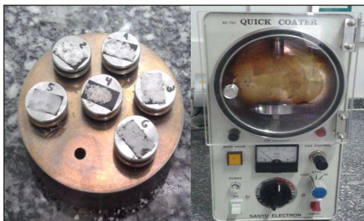
Figura 3.6. Portas-amostra e metalizador utilizados para a preparação das micrografias (O AUTOR, 2017).
