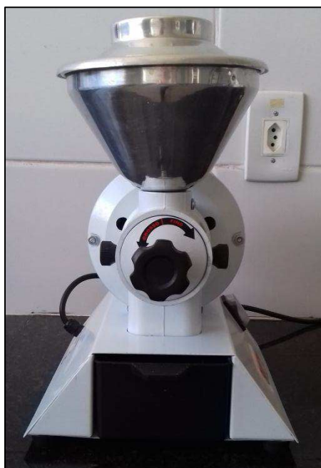
Figura 3.1. Moinho industrial utilizado para obtenção da farinha de arroz vermelho (O AUTOR, 2016).
