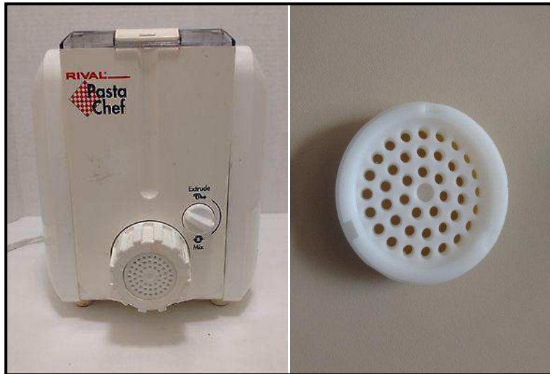
Figura 3.2. Máquina multifuncional RIVAL® PASTA CHEF e detalhe ampliado do molde para a obtenção do formato espaguete (O AUTOR, 2015).
