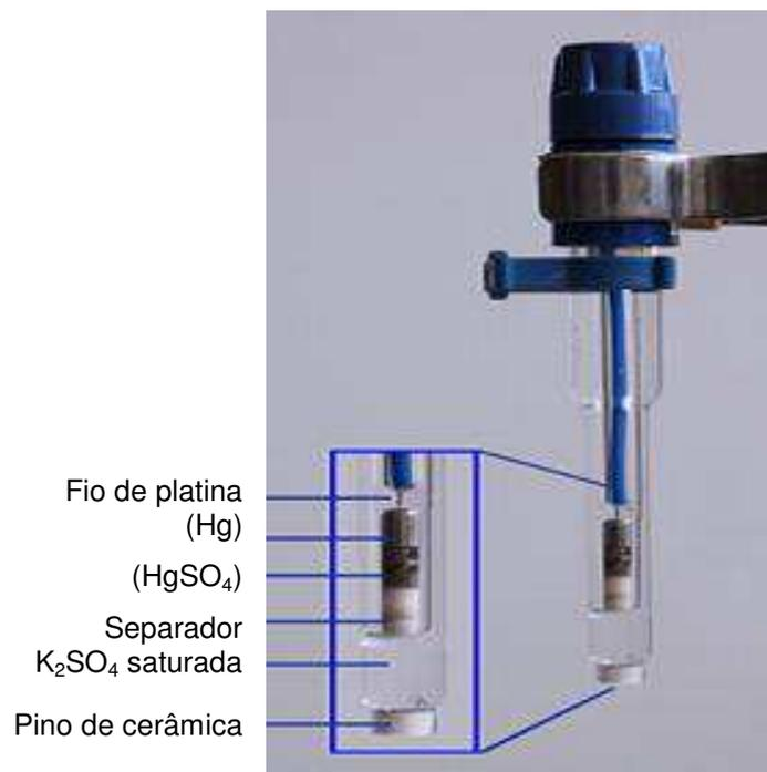
Figura 19 - Ilustração esquemática de um eletrodo MSRE. Fonte – (VILAR, 2014)
