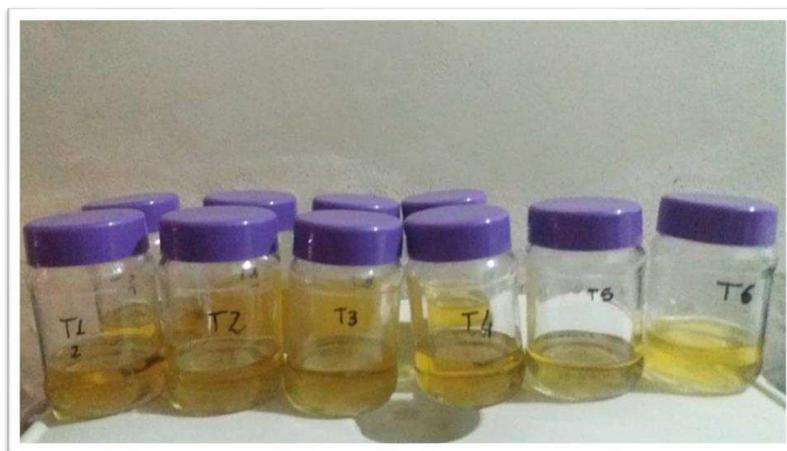
**Figura 4.20** – Biodiesel obtido com CAP, como catalisador.
