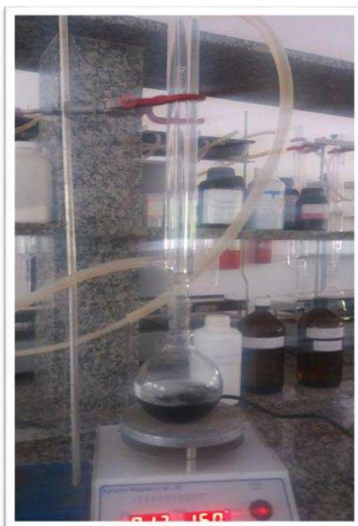
**Figura 3.14** – Esquema reacional para a síntese de biodiesel em sistema aberto.
