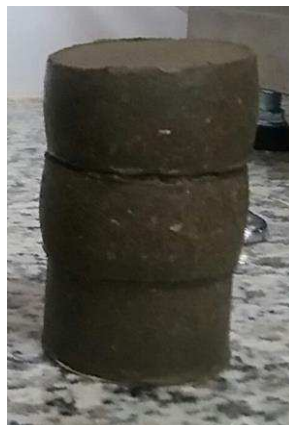
Figura 43: Solo reforçado com geotêxtil após realização do ensaio triaxial
