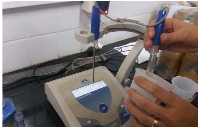
Figura 17: Realização do ensaio de pH do solo.
