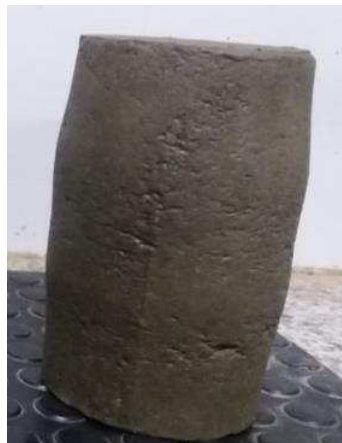
Figura 46: Solo reforçado com geogrelha
