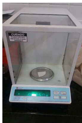
Figura 19: Pesagem do Papel Filtro usado no ensaio de curva característica.
