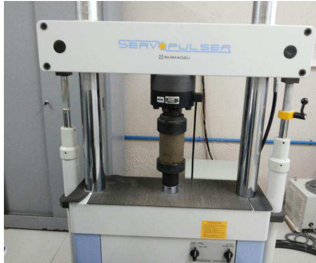
Figura 20: Prensa automática utilizada no ensaio de resistência à compressão simples.
