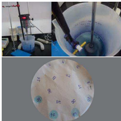
Figura 16: Equipamento utilizado para realização do ensaio de azul de metileno
