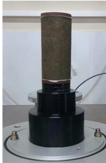
Figura 22: Colocação do corpo de prova sob a base da câmara triaxial
