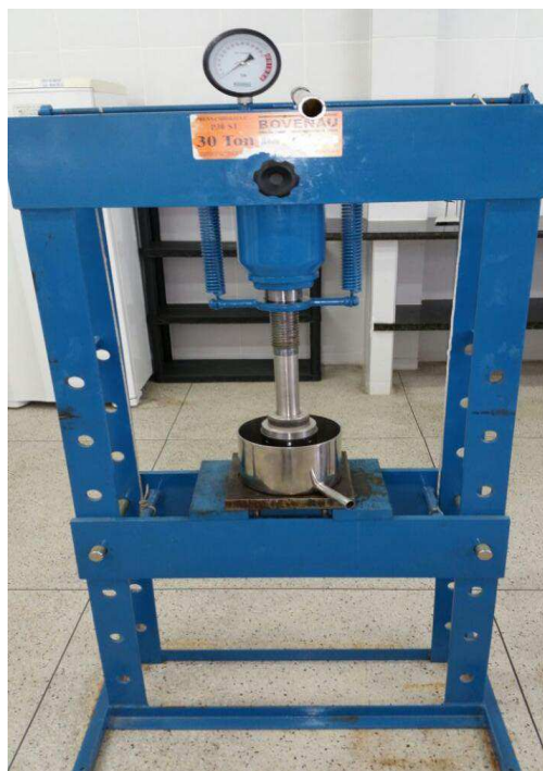
Figura II.3.1 - Prensa hidráulica utilizada para extração do óleo das sementes de gergelim
