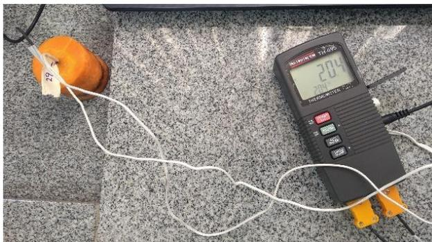
Figura 3.13 - Termopar acoplado a uma peça de cenoura e conectado ao termômetro.
