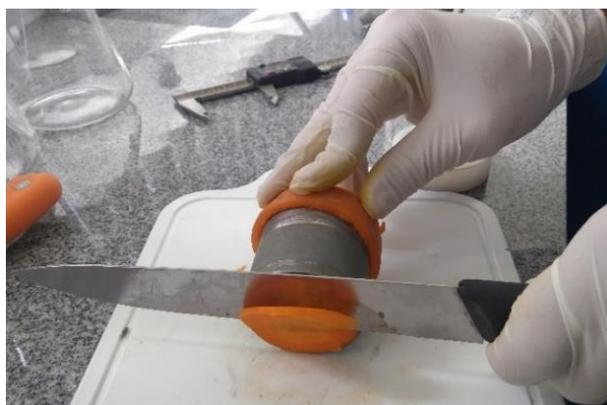
Figura 3.10 - Remoção dos excessos laterais e definição das bases do cilindro.
