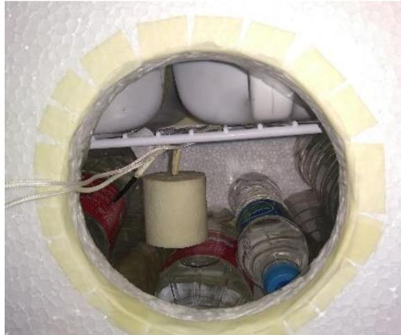
Figura 3.14 - Peça de macaxeira suspensa no interior do frigobar para resfriamento.
