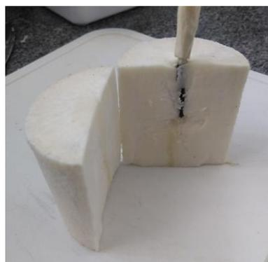
Figura 3.15 – Peça de macaxeira cortada ao meio no sentido longitudinal: o corte possibilita aferir a real posição do termopar.
