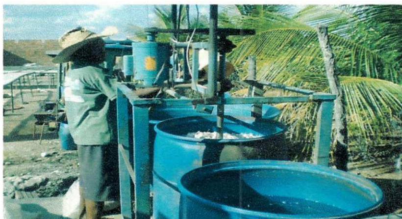
Figura 5 - Máquina de Lavagem da Matéria Prima (Artesanal) Fonte: Dados da Pesquisa, 2008
