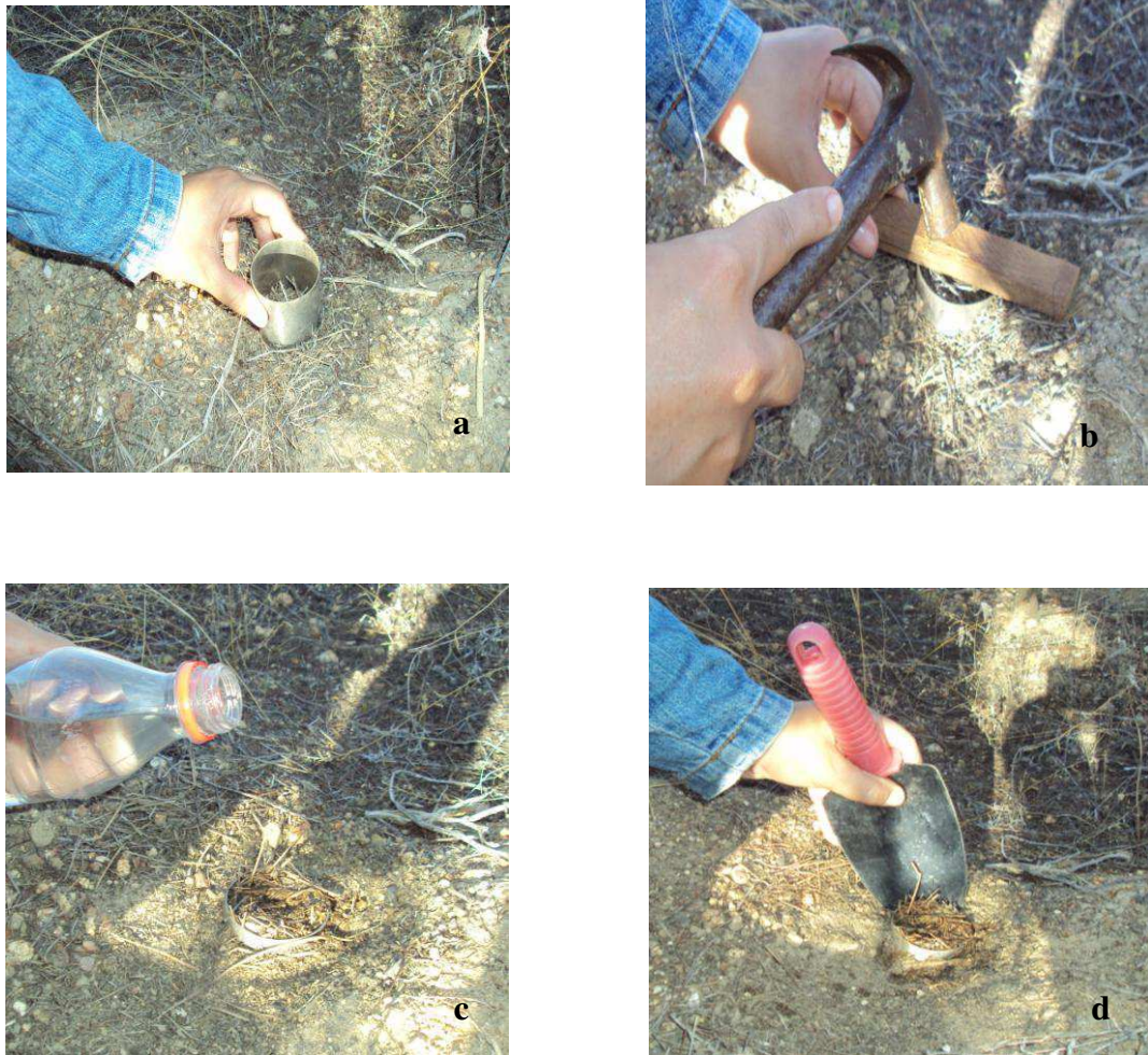
Figura 3 – Introdução do anel metálico no solo (a e b), umedecimento e remoção do anel metálico do solo com amostras utilizando uma espátula (c e d).
