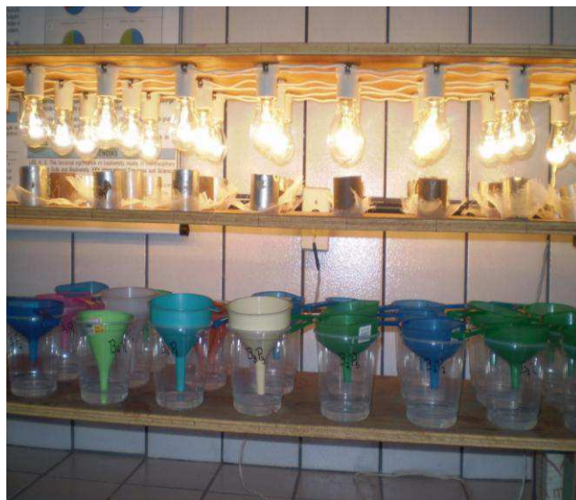
Figura 4 – Extração da mesofauna edáfica empregando o equipamento de Berlese-Tullgren modificado.
