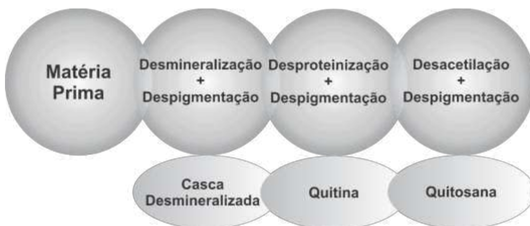
Figura 4 – Fluxograma esquemático das etapas de extração de quitina e obtenção de quitosana.
