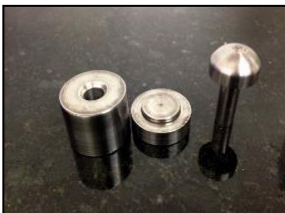
Figura 8 - Molde utilizado para conformar os corpos de provas. Fonte: Própria (2017).
