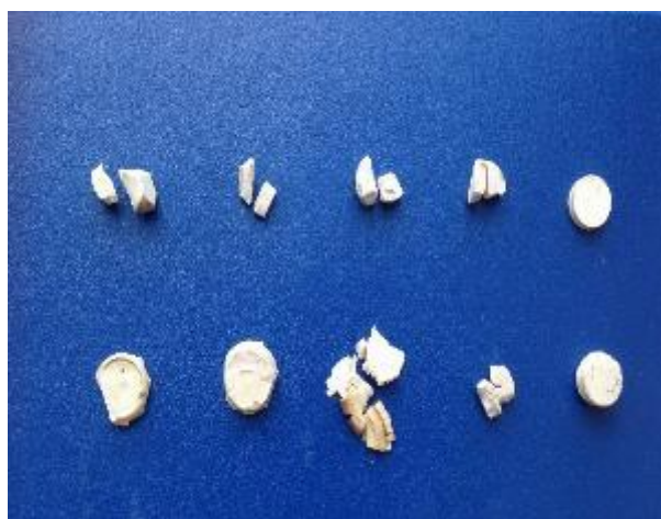
Figura 10- Peças de PEEK produzidas utilizando molde com resistência acoplada. Fonte: Própria (2017).
