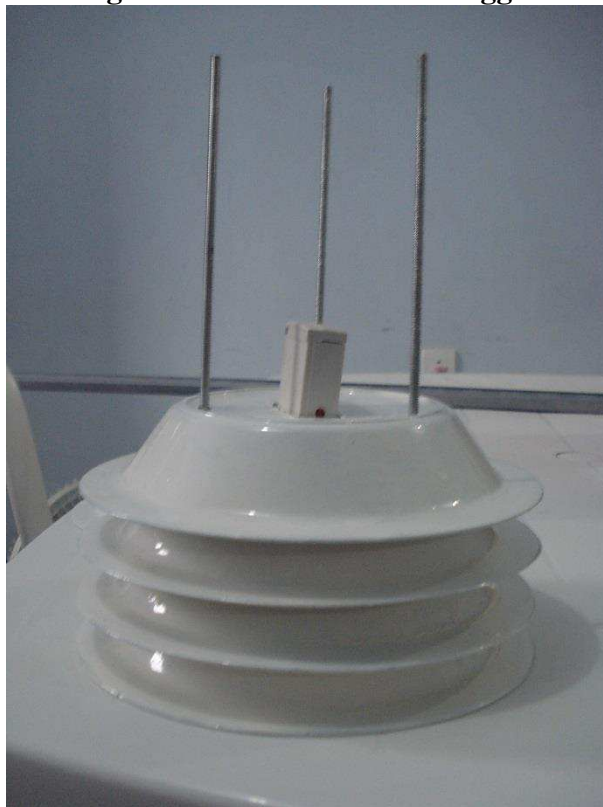
Figura 15 – AMA com o registrador HOBO® Data Logger U10-003 em seu interior
