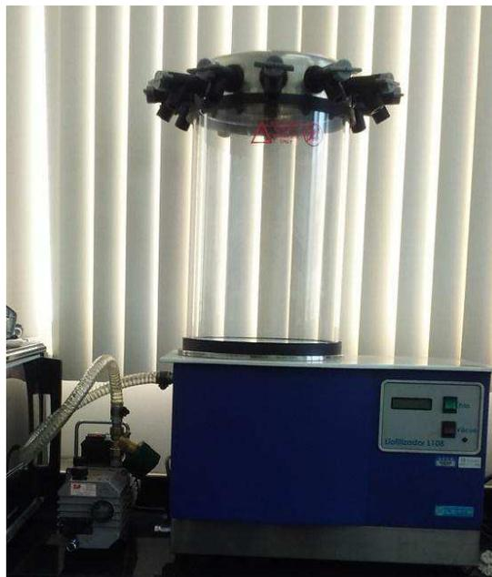
Figura 3 - Liofilizador L108 da marca LIOTOP
