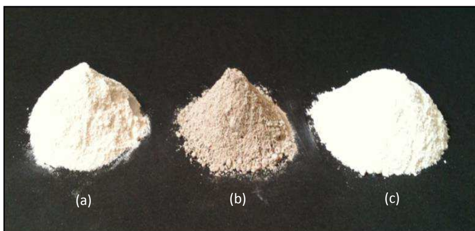
Figura 8 – Resíduos de caulim (a), granito (b) e mármore (c) após beneficiamento em laboratório
