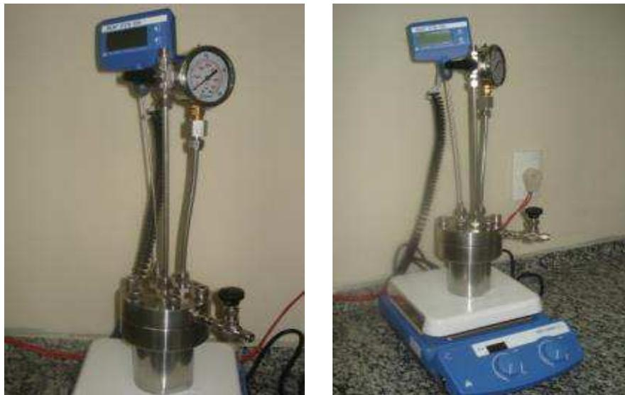
**Figura 12** - Fotografia do reator de aço inox para biodiesel (Dantas, 2012).
