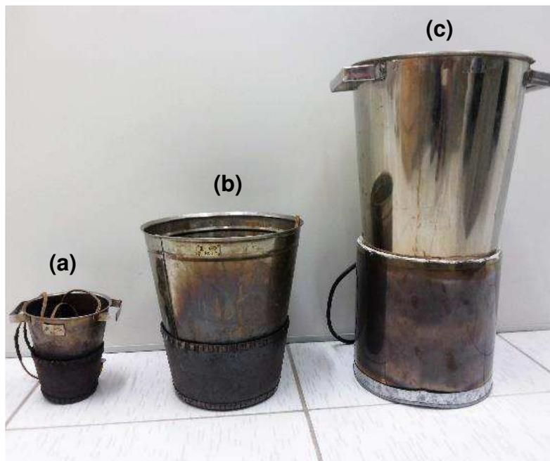
**Figura 11** - Recipientes utilizados nas sínteses por reação de combustão: (a) P01, (b) R01 e (c) R12 (Autoria própria, 2015).
