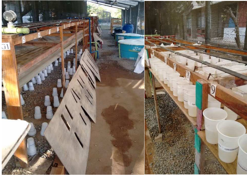
Figura 4 - Bancadas experimentais: vista longitudinal (a), detalhe das prateleiras removíveis. Campina Grande – PB, 2016.
