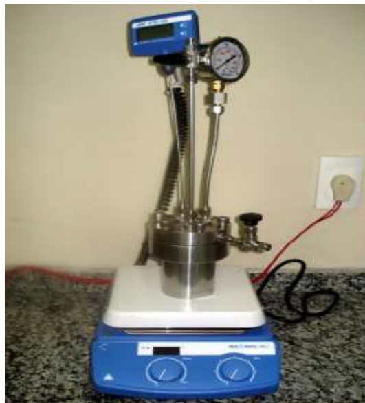
Figura 15 - Reator de aço inox utilizado nas reações de esterificação.
