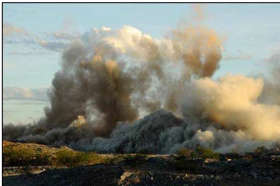
Figura 13 – Geração de poeiras e gases após detonação
