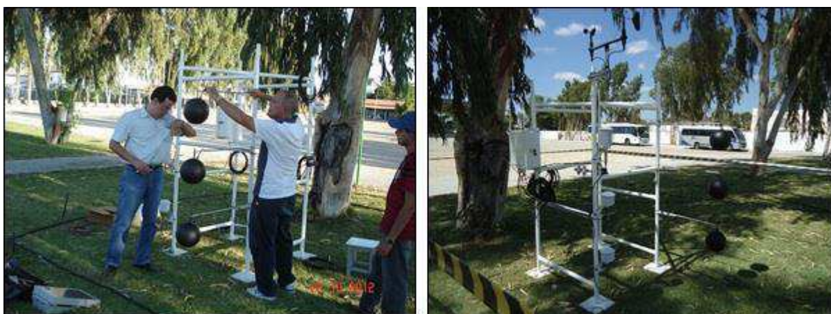
Figura 16 – Estação meteorológica 11, na área urbana de Juazeiro-BA, com influência de sombreamento pela arborização.
