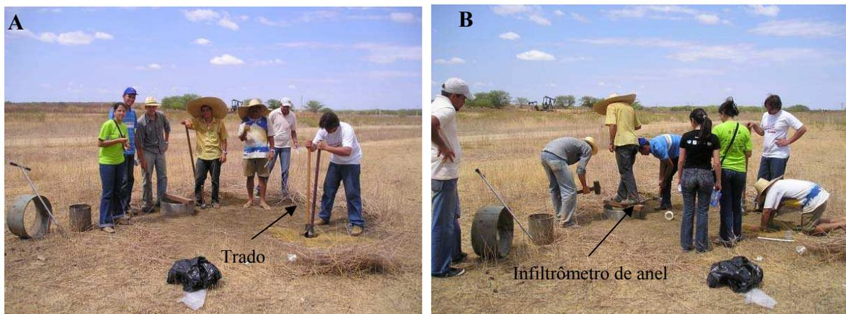
Figura 6.43 – Ponto X-5 – Neossolos Litólicos. (A) Realização da coleta da amostra de solo com trado. (B) Ensaio de infiltração (Infiltrômetro de anel).
