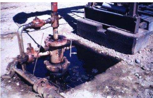
Figura 6.12 – Cisterna entupida com acúmulo de óleo, com risco de incêndio e de infiltração no solo
