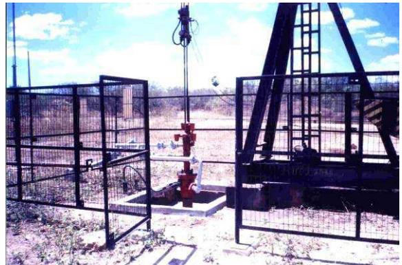
Figura 6.17 – Detalhe da estrutura de segurança do poço
