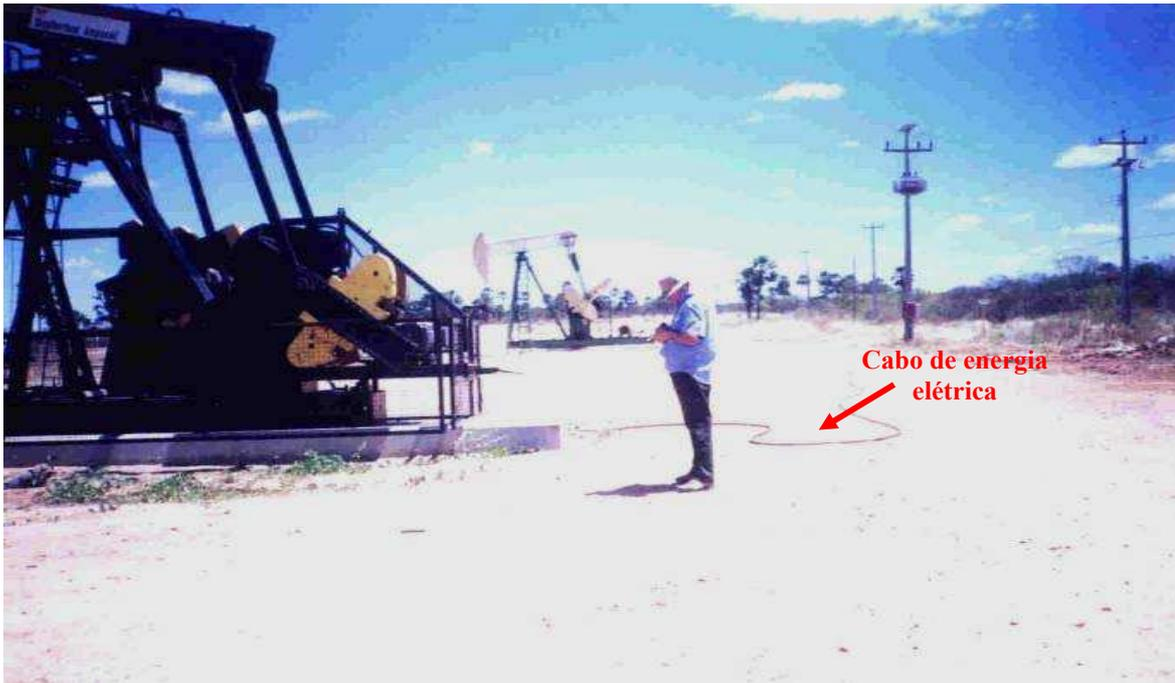
Figura 6.9 – Cabo de energia elétrica solto no o solo, sobre o qual há tráfico de veículos
