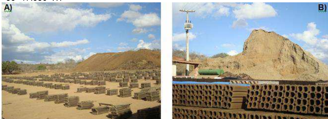
Figura 9: A) Estoque de argila e secagem de telhas, cerâmica em Picuí. B) Estoques de argila e secagem de tijolos. Coordenadas da Figura: 6° 32. 683' S e 36° 17.930' W.
