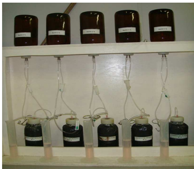
FIGURA 6.16 – Aparato para Atividade Metanogênica Específica – AME.
