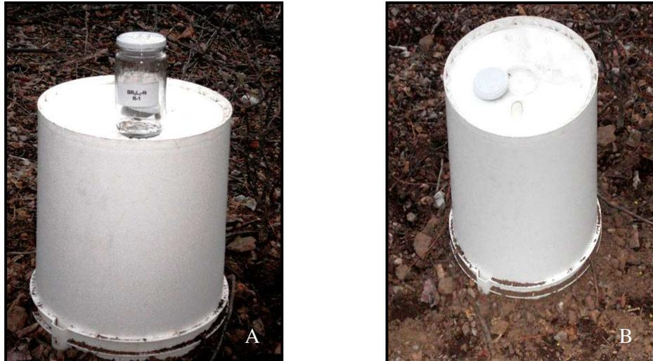
Figura 3. Frasco de vidro contendo solução 10 ml de KOH 0,5N (A) e balde de PVC cobrindo a amostra visão da amontoa de solo nas bordas (B).
