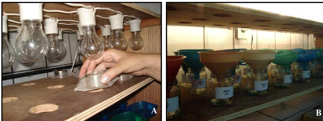
Figura 9. Vista da colocação dos anéis com a amostra para a separação da mesofauna edáfica (A) e funis para a coleta os organismos e fixação no álcool a 70% (B) utilizando o equipamento de Berlese-Tullgren modificado.
