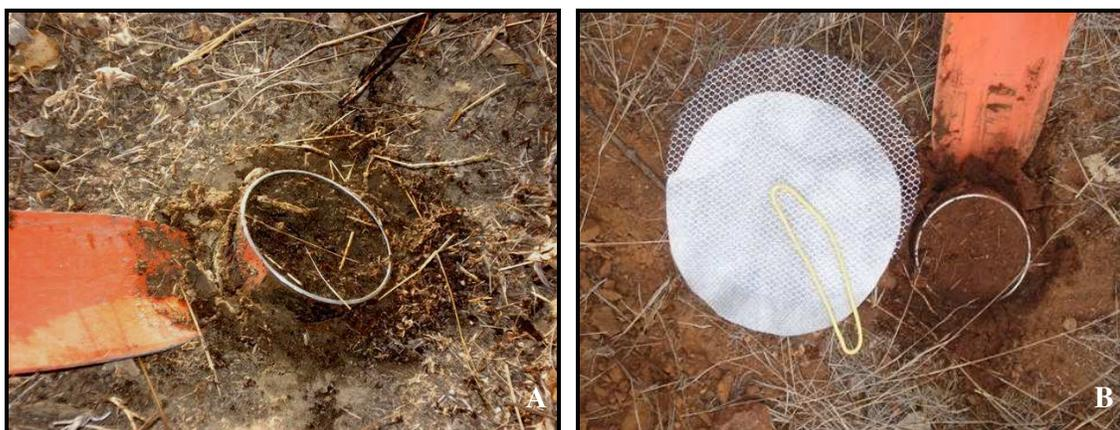
Figura 8. Vista do solo umedecido para a retirada da amostra da mesofauna utilizando anéis metálicos (A) e disco de TNT e filo para acomodação da amostra (B).
