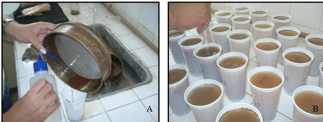
Figura 6. Transferência do material após lavagem para copos descartáveis de 500 ml (A) e agitação com bastão de vidro para flotação da MOL (B).
