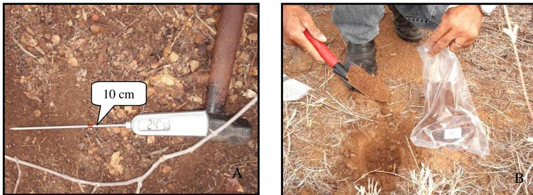
Figura 4. Determinação da temperatura do solo na superfície e a 10 cm, com termômetro digital (A) e retirada de amostra do solo na profundidade de 10 cm para a determinação do conteúdo de água (B).
