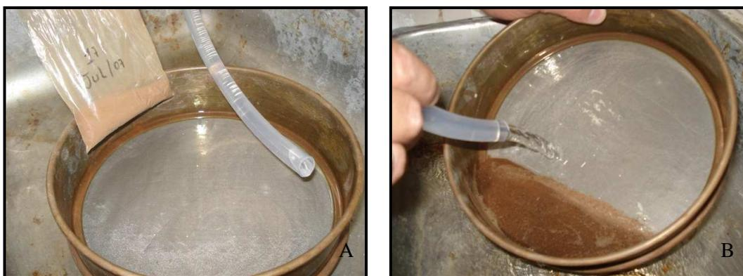
Figura 5. Amostra de solo TFSA após peneiramento (A) e processo de lavagem da amostra em água corrente (B).
