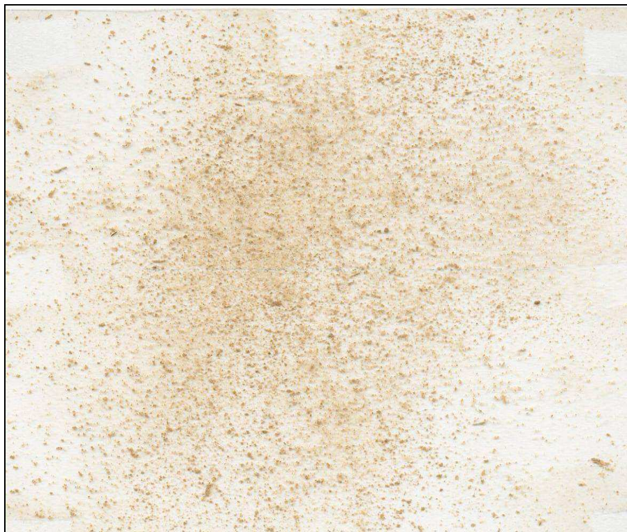
Figura 11. Mecanismo de Mensuração em Contato com os Poluentes Atmosféricos: Peso ( P_2 ) = 1, 022g
