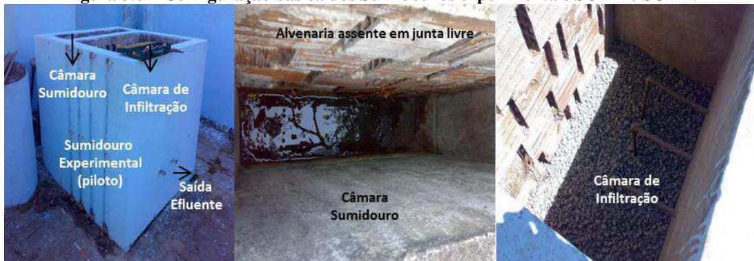
Figura 3.8 – Configuração básica dos Sumidouros experimentais SUM1 e SUM2.
